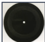
Un coloris plaxé standard noir après 10 cycles d'abrasion : une décoloration apparaît de façon précoce .
