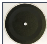
Un coloris plaxé standard noir après 100 cycles d'abrasion : une décoloration clairement visible avec le changement de brillance .
